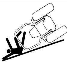
1. KUBOTA recommande l'utilisation d'une structure de protection (ARCEAU) et d'une ceinture de sécurité dans la plupart des applications.
