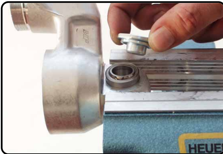
Lager KGW mit angeschrägter Seite mit Montage-Zwischenstück T1206 in Federbeingehäuse einsetzen.
