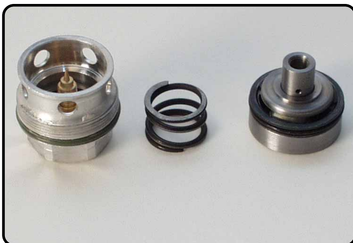
Schraubdeckel mit Stellnadel, Feder und MCC-Dämpfungshalter.
