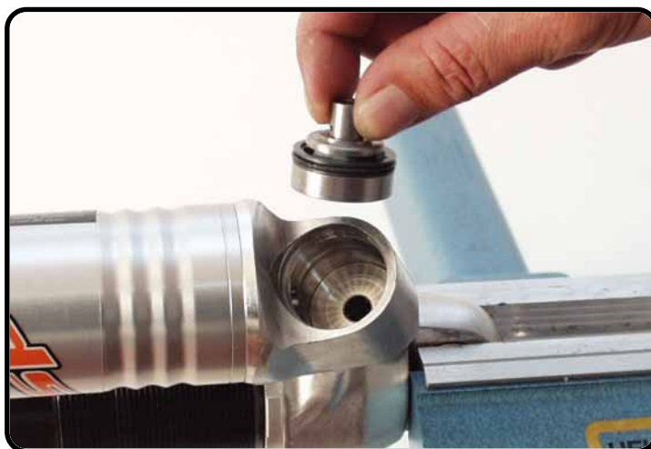
Dämpfungsadapter aus Federbeingehäuse ziehen.
